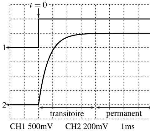
Figure 8.2 – Formes d'onde d'un essai indiciel.
